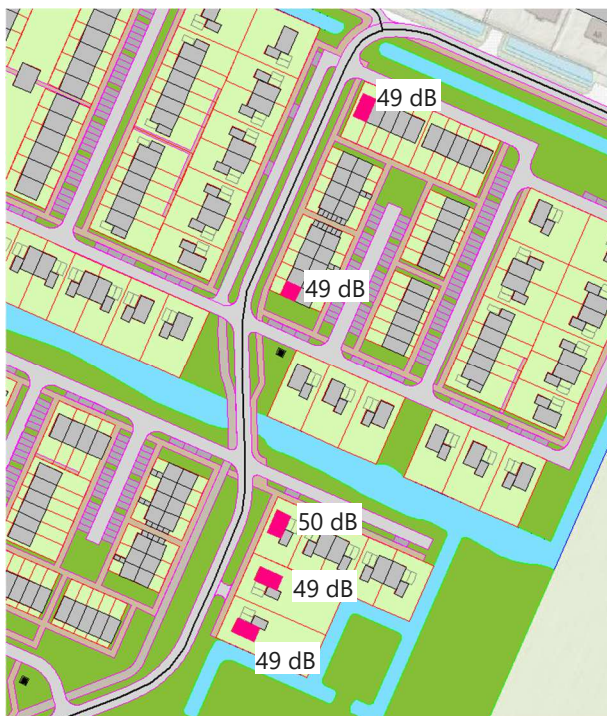
Figuur 4.1 Nieuwe woningen met geluidsbelastingen hoger dan 48 dB t.g.v. de nieuwe verbindingsweg
